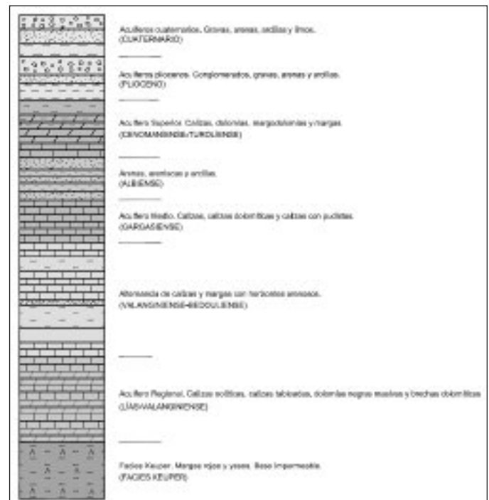
Fig. 3. Esquema vertical sintético de distribución de los acuíferos en el área del Maestrazgo (sin escala) Fig. 3. Synthetic vertical scheme of aquifers distribution in Maestrazgo area (without scale)
